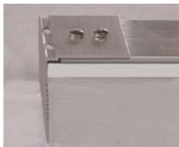
Die Alu-Haltewinkel werden an den unteren Stirnseiten der Mittel- und Randprofile mit je 2 Schrauben 4,8 x 16 mm befestigt.
